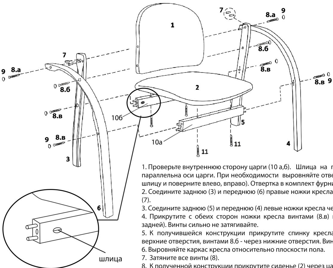
1. Проверьте внутреннюю сторону царги (10 а, б). Шлица на гайке должна быть строго параллельна оси царги. При необходимости выровняйте отверткой (вставьте отвертку в шлицу и поверните влево, вправо). Отвертка в комплект фурнитуры не входит.
